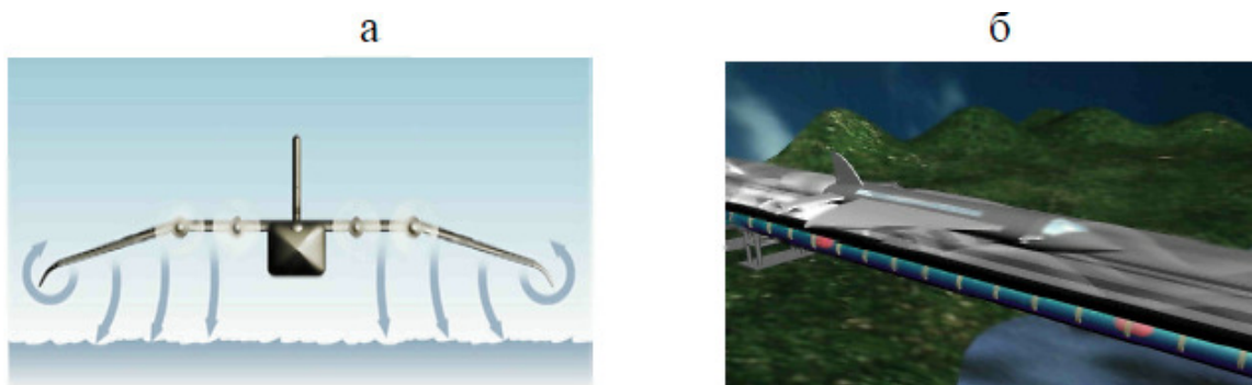
Рис. 3. а – поддувная система ЛА; б – эстакада желобообразной формой в виде параболы. Fig. 3. a - blow-up system of the LA; b - trestle with a trough shape in the form of a parabola.
